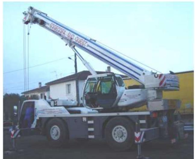
Compte tenu du poids important, (6 T pour un ensemble de 5 m<sup>3</sup>) la manutention est réalisée au moyen d'une grue auto-portée 35 T.
