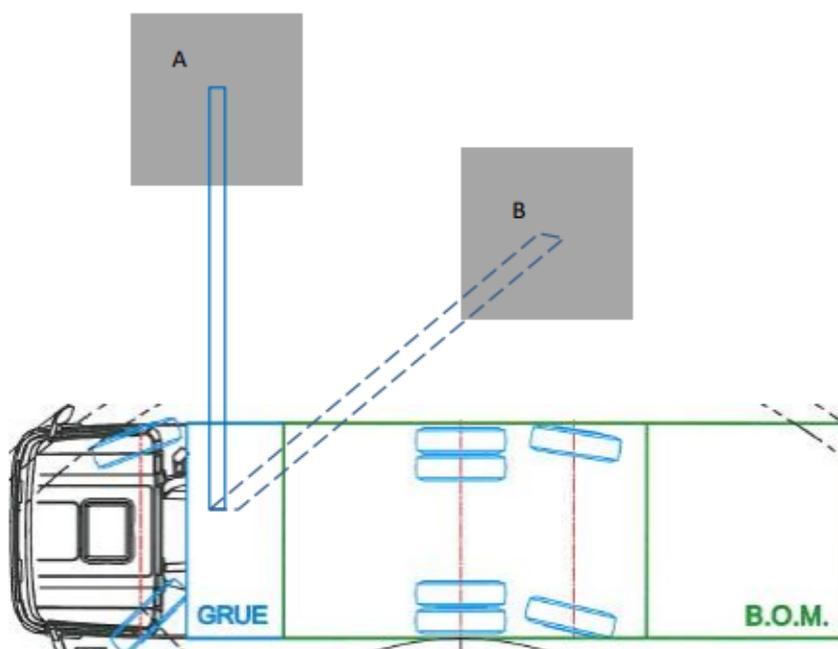
**4.7 Disposition des bornes :** les bornes de verre puis d'ordures ménagères étant les plus denses, il est conseillé de les placer au plus près de l'emplacement dédié au camion de collecte et au plus proche de l'emplacement optimal.
